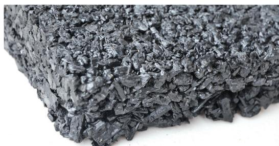
▲多孔隙的生物炭，能發揮封存溫室氣體、改良土壤、除臭、提升碳匯儲存量等多樣功能。
