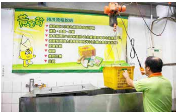
八里區農會使用的鮮筍浸水式預冷設備。(來源：劉懿萱，2023/12/3)
